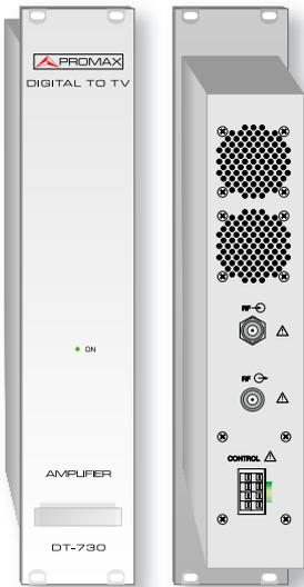
**DT-730** ist ein leistungsfähiger 1 W HF-Leistungsverstärker für COFDM-Signale, der sowohl für Einzel- als auch für Mehrträger-Systeme (\*) einsetzbar ist. Er liefert ein auf 137 dBµV (+30 dBm) verstärktes Ausgangssignal.
